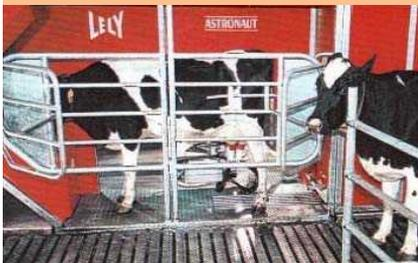
労働時間の約5割を占める搾乳作業を自動化
