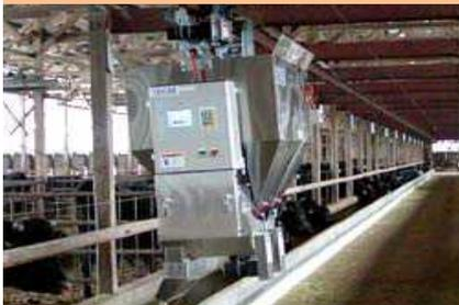
労働時間の約2割を占め、人力での運搬が重労働である給餌作業を自動化
